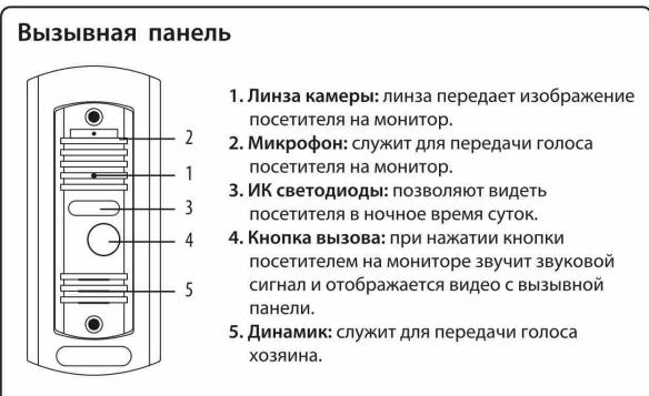
1. Линза камеры: линза передает изображение посетителя на монитор.
